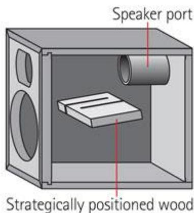
Per evitare vibrazioni indesiderate del cabinet Yamaha ha sviluppato una struttura interna chiamata VCCS (Vibration Control Cabinet Structure) che utilizza il posizionamento in zone strategiche di materiale composto in grado di fornire un eccellente isolamento dalle vibrazioni. In aggiunta il treppiede fornisce un assorbimento delle vibrazioni ulteriore, migliorando considerevolmente la qualità audio.
