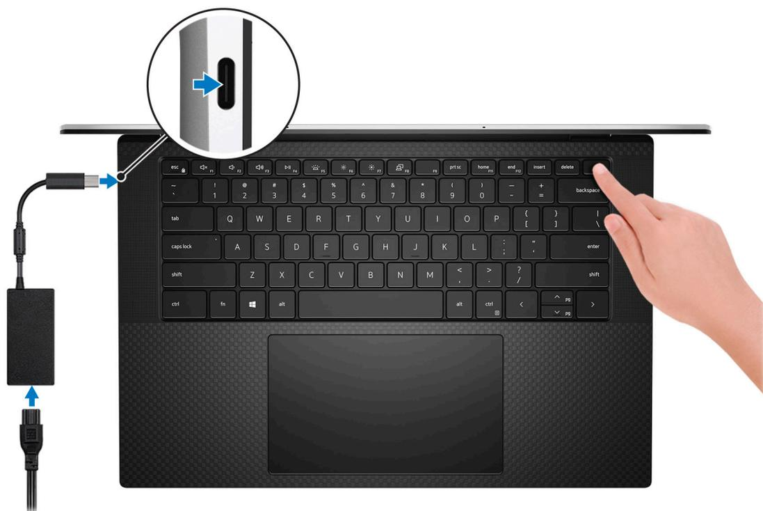
**N.B.:** È possibile caricare il sistema collegando l'adattatore di alimentazione a una delle porte Thunderbolt 3 (USB Type-C) che si trovano sul lato sinistro del computer o alla porta USB 3.2 Gen 2 (Type-C) che si trova sul lato destro del computer.
