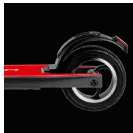
Ruote piene: anteriore 6", posteriore 5,5"
