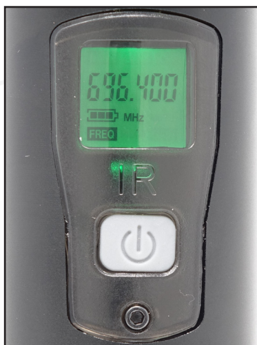
Display LCD con indicazioni su Frequenza e stato delle batterie
