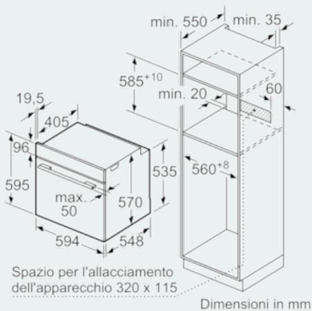
Montaggio con un piano di cottura.
