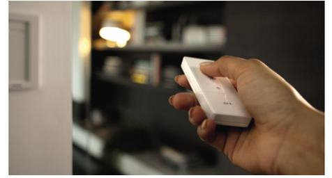
Con il dimmer a batterie puoi controllare simultaneamente fino a 10 luci connesse. L'interruttore, che può essere rimosso dal montaggio a parete e utilizzato come telecomando, ti consente di ridurre e aumentare la luminosità delle luci o di scegliere tra 4 diverse modalità di illuminazione programmate.
